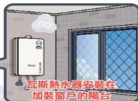
屋外式瓦斯熱水器 安裝在窗戶緊閉的陽台
