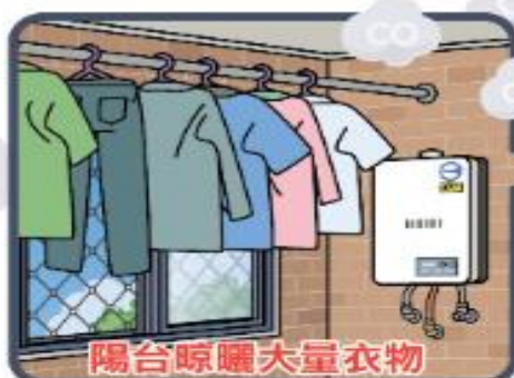
屋外式瓦斯熱水器 安裝在室內
