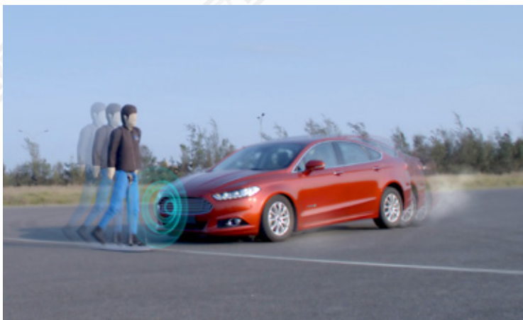
▲ 自動緊急煞車系統 (AEB) 示意圖
